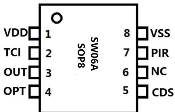
人体热释红外线感应控制 IC（延时时间可调、光敏可调）
