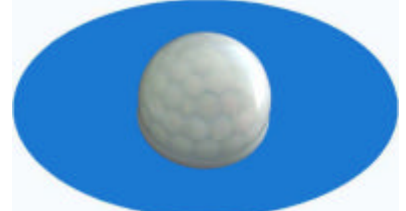
型号：8050 焦距：50 角度：120° 距离：8m 尺寸：内径?95.8 外径?100
