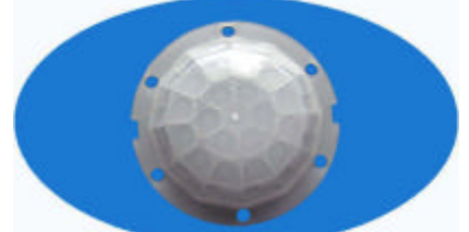
型号：8604-2 焦距：18 角度：120° 距离：10m 尺寸：内径36.0 外径43.5
