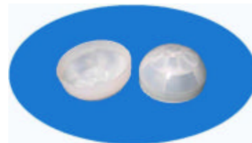
型号：2814 焦距：10.5 角度：140° 距离：6m 尺寸：28 厚度:0.6
